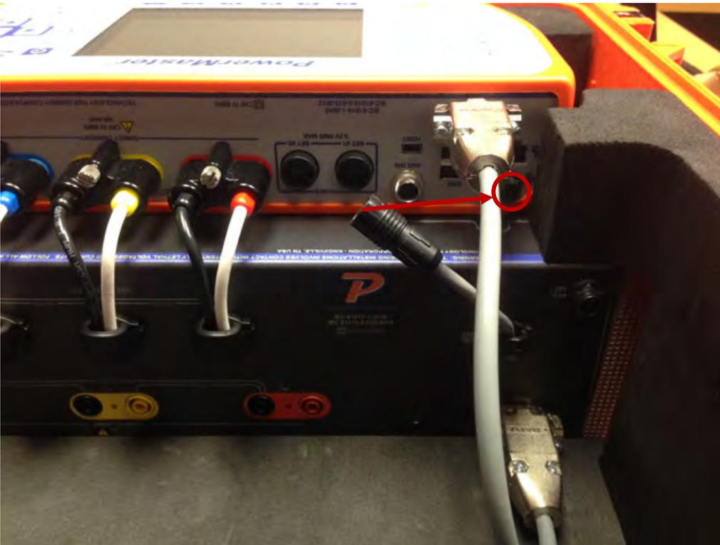
4. Antes de realizar la prueba, conecte las pico de pato al 303/305/335 y conecte la sonda de voltaje al PowerMaster series 3
