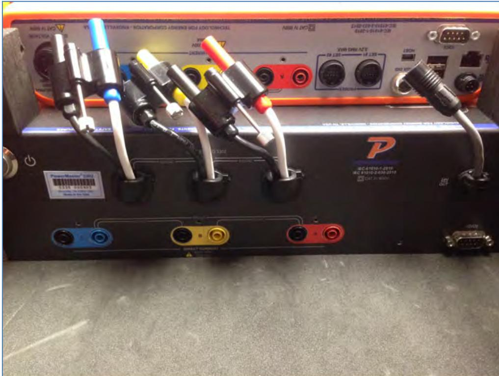
1. Conecte los puentes actuales como se muestra a continuación. Verifique que los colores en los conectores de tipo banana, y que el tornillo de seguridad esté firmemente apretado.
