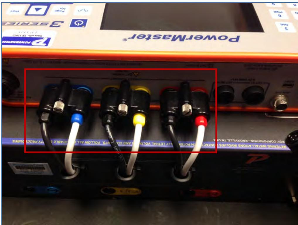
2. Luego, conecte el cable de comunicación del 303/305/335 a la serie 3.
