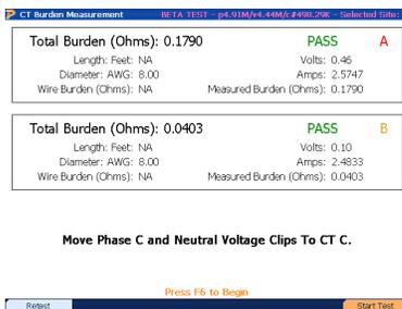
Pulse F6 para someter a prueba el TC de la fase C
