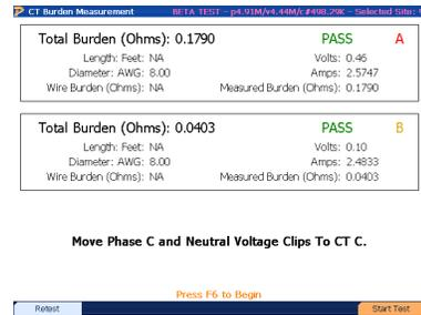
Pulse F6 para someter a prueba el TC de la fase C
